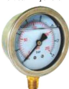
*Indicados para bombas, compressores e máquinas ou equipamentos onde há vibração ou pulsação constantes. Devido a glicerina, as oscilações dos componentes internos são amenizadas, proporcionando leitura mais precisa, redução considerável no desgaste dos materiais e maior durabilidade.*
